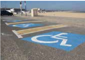
រូបភាព ២.៣.៥. គំរូអំពីទីធ្លាសមល្មមសម្រាប់ ការចតយានយន្តជនមានពិការភាពនីមួយៗ គួរកត់សម្គាល់ថារូបភាពនេះមិនបានដាក់ស្លាក សញ្ញាអន្តរជាតិសម្គាល់ទីតាំងចំណតនិង ជម្រាលចុះឡើងខ្សែន។
